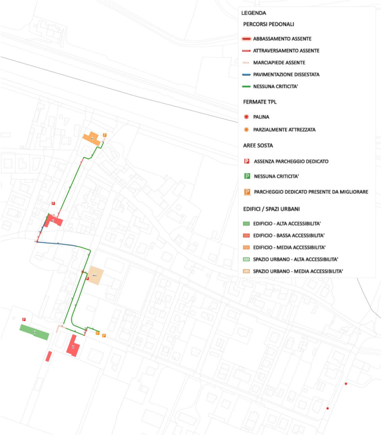
Figura 2 – Localizzazione delle barriere architettoniche rilevate lungo i percorsi pedonali principali, dei parcheggi e delle fermate del trasporto pubblico - Capoluogo
