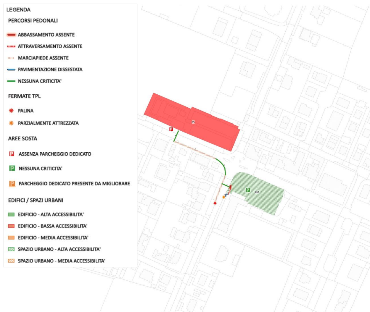
Figura 3 – Localizzazione delle barriere architettoniche rilevate lungo i percorsi pedonali principali, dei parcheggi e delle fermate del trasporto pubblico - Chiesa
